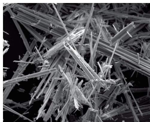
F247: Microscopische opname van een asbestvezel.
