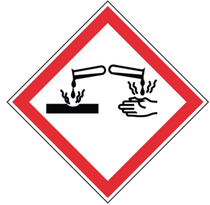
F242: Corrosief/Bijtend (C)
